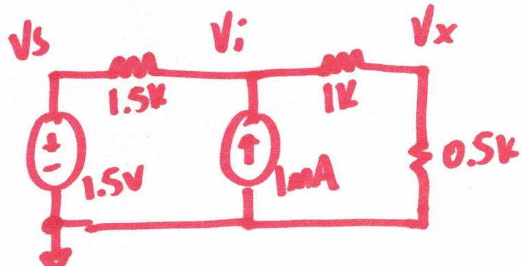
$$V_x = V_{x_1} + V_{x_2}$$
